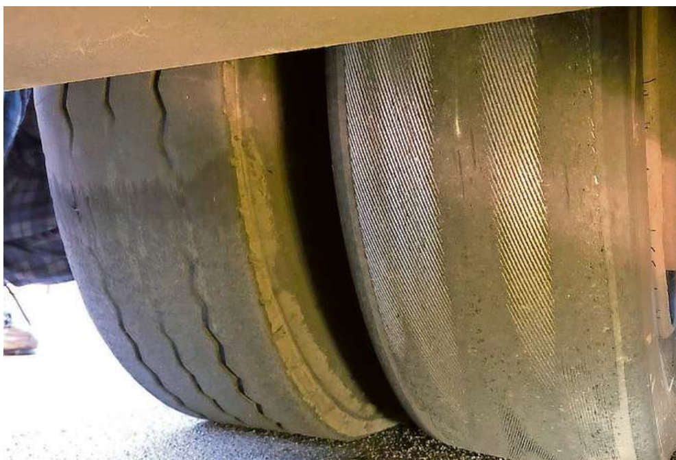
Die Reifen des Autotransporters sind teilweise bis auf die Karkasse abgefahren.
